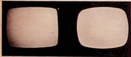
Links das Bildfenster der neuen Westinghouse-Flachschirm-Röhre mit 58 cm Diagonale im Vergleich zu einer normalen 53-cm-Bildröhre (rechts)
