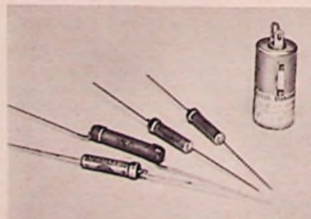
Bild 3. Die kleinste Stabilyt-Zelle Typ 10 hat nur etwa die Größe eines 0,5-W-Widerstandes; daneben eine Zelle Typ 150
