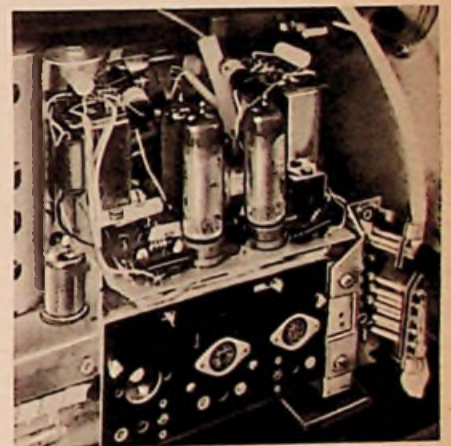
Bild 2. Blick auf den Nf-Teil des Nordmende-Othello
